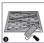
Нанесите «клей специальный Artpole» с помощью валика или шпателя на стену, затем нанесите клей на всю обратную сторону панели.
