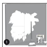
Стены должны иметь ровную поверхность. Не должно быть старых обоев. Чем ровнее стена, тем ровнее стыки и менее заметен заделанный шов. Стену рекомендуем прогрунтовать акриловым грунтом общего назначения (обычной строительной грунтовки глубокого проникновения), грунт дает защитную пленку и улучшает сцепление панели со стеной.
