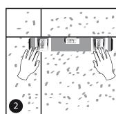
Разметьте поверхность с помощью уровня или отвеса. Определите общий контур композиции и ее место на стене. Произведите разметку стены вертикальными и горизонтальными линиями таким образом, чтобы получить "сетку-шаблон", которая поможет аккуратно наклеить панели на стену.
