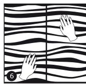
При приклеивании последующих панелей возможно небольшое их перемещение после соприкосновения со стеной (в течении 30-60 сек.) для стыковки рисунка. Время полного схватывания клея смотрите на упаковке. Для дополнительной временной фиксации панелей до полного
